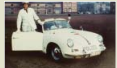
Porsche 354 B Cabrio Funkstreifenwagen der Autobahnpolizei Stuttgart; Typ 1600 S-90, 1582 cm 3 , 90 PS, 185 km/h, 1962
